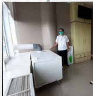
Fasilitas Portable Exhaust Hepafilter yang didesain dan diproduksi oleh Workshop PT Semen Padang untuk penanganan COVID-19 di Semen Padang Hospital
